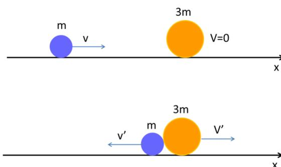
$$\begin{cases} mv + 3mV = mv' + 3mV' & \text{conservazione della quantità di moto} \\ \frac{1}{2}mv^2 + \frac{1}{2}(3m)V^2 = \frac{1}{2}mv'^2 + \frac{1}{2}(3m)V'^2 & \text{conservazione dell'energia cinetica} \end{cases}$$
