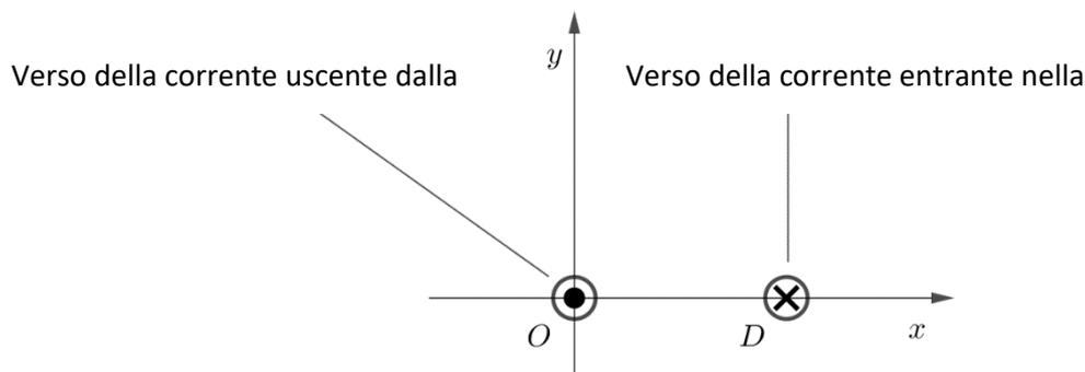
1. Verificare che l'intensità del campo magnetico  $\vec{B}$ , espresso in tesla (T), in un punto  $P(x, 0)$ , con  $0 < x < 1$ , è data dalla funzione  $B(x) = K \left( \frac{1}{x} + \frac{1}{1-x} \right)$ , dove  $K$  è una costante positiva della quale si richiede l'unità di misura. Stabilire quali sono la direzione e il verso del vettore  $\vec{B}$  al variare di  $x$  nell'intervallo  $(0, 1)$ . Per quale valore di  $x$  l'intensità di  $\vec{B}$  è minima?
