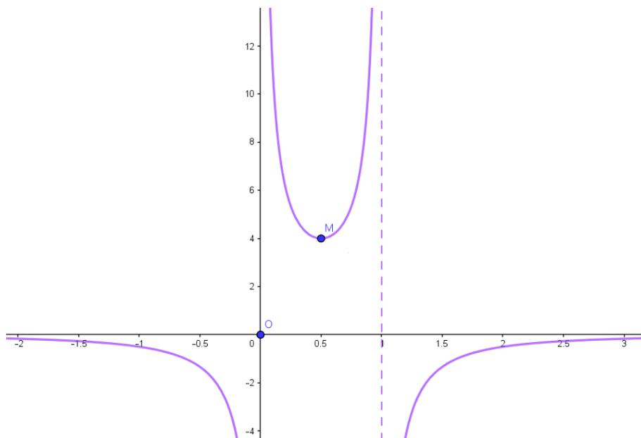
e che la derivata:  $\frac{2x-1}{x^2(x-1)^2}$  fornisce un minimo a  $x=1/2$ , l'intensità minima di B si ha nel punto medio fra O e D.
